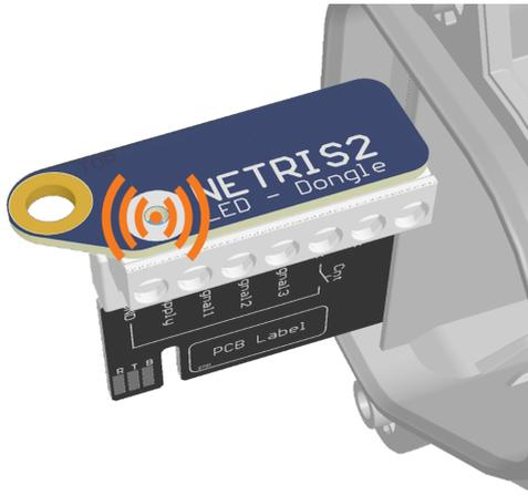
Abbildung 5: NETRIS®2 mit angeschlossenem NETRIS®2-LED-Dongle
